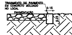
05 - DETALHE TRAVAMENTO ESCALA 1/30
