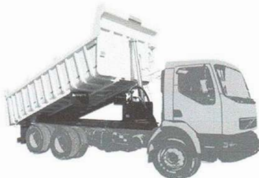
FIGURA 2. Caminhão Semi-Pesado Chassis Toco Tipo Caçamba Basculante 12m 3
