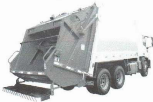
FIGURA 1. Caminhão Semi-Pesado Chassis Toco Tipo Compactador 12m 3 e 15m 3
