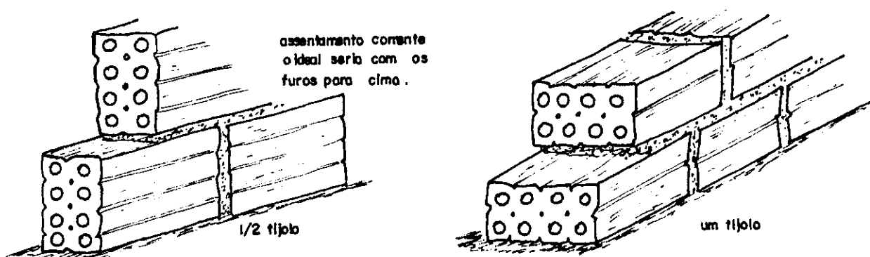
Figura 1 - Execução de alvenaria utilizando tijolos furados.
