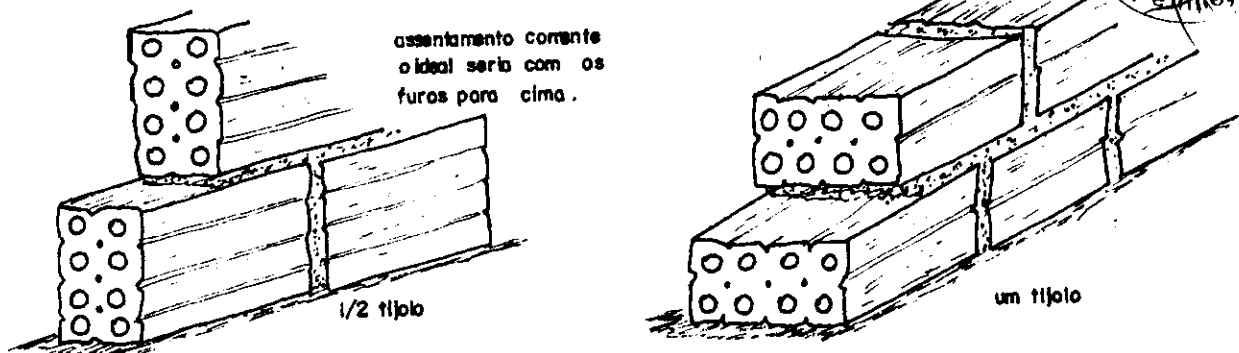
Figura 1 - Execução de alvenaria utilizando tijolos furados.
