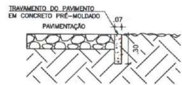
DETALHE TRAVAMENTO DO PAVIMENTO ESCALA: 1/25
